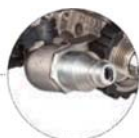
ช่องจ่ายอากาศเอนกประสงค์
